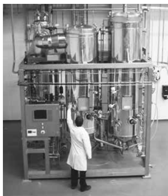
Evaporateur à film tombant ATEX 200L/h (FRANCE EVAPORATION) ©PURIFUNCTION
